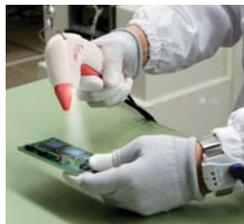
手元作業に適したエア圧力で良好な除電性能です。
