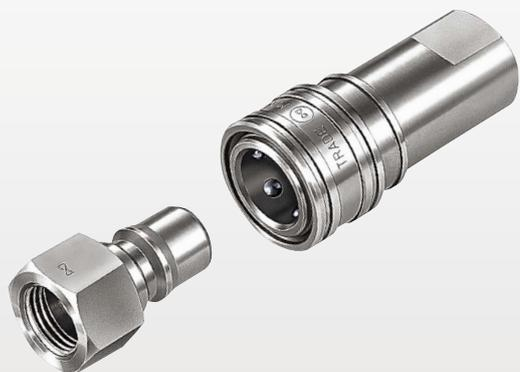
本体材質にステンレス鋼を採用、シール材にゴムを使用した汎用型。電解研磨処理を施して耐食性が向上。
