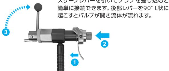
スリーブレバーを引いてプラグを差し込むと簡単に接続できます。後部レバーを90° L状に起こすとバルブが開き流体が流れます。
