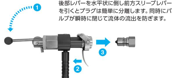
後部レバーを水平状に倒し前方スリーブレバーを引くとプラグは簡単に分離します。同時にバルブが瞬時に閉じて流体の流出を防ぎます。
