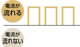
インバーターの能力で、ON (電源が流れる) とOFF (流れない) を作り出します。
