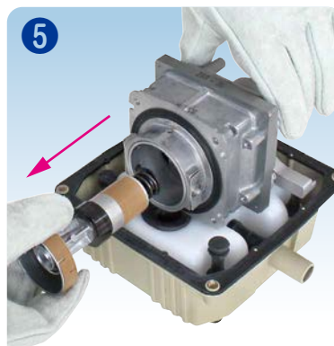
シリンダカバーをはずしてピストンを取り出す。
