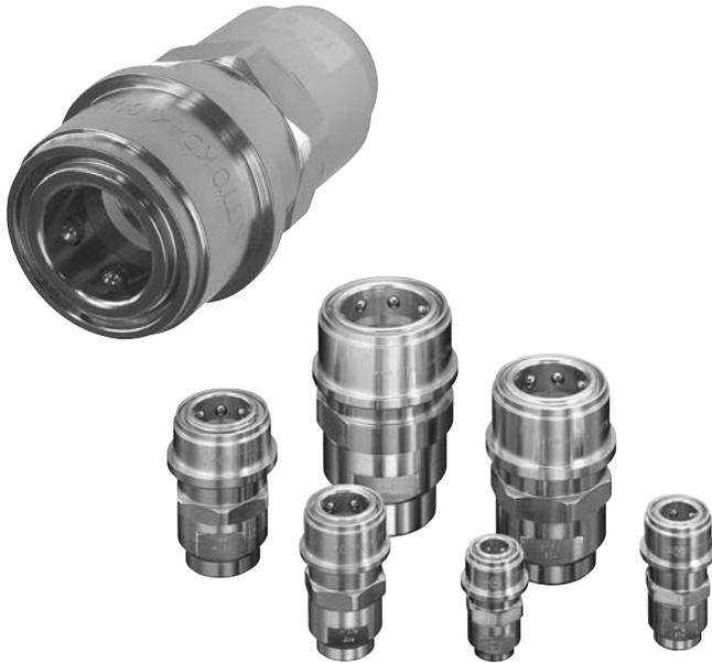
接続荷重の低減とパーティクル発生抑制のためシール部にふっ素樹脂シールを採用。二重シール構造で高シール性も実現。
